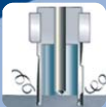
Durante a furação, há a retração do piloto. O piloto controla também a refrigeração.
